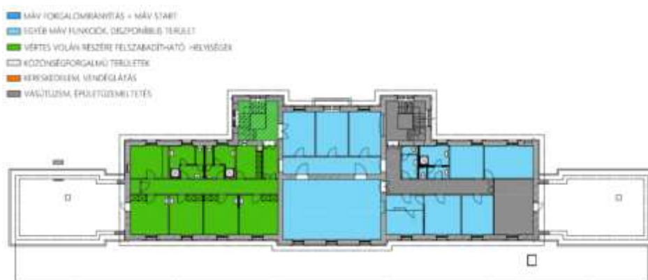
191. ábra A felvételi épület emeleti alaprajza a lehetséges Volán funkciók átrendezésével 1. megoldás
