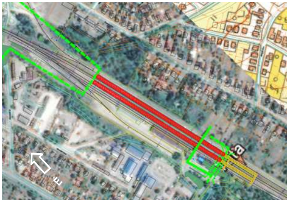
175. ábra A személyforgalmi peronok északi irányba történő „elmozdítása”
