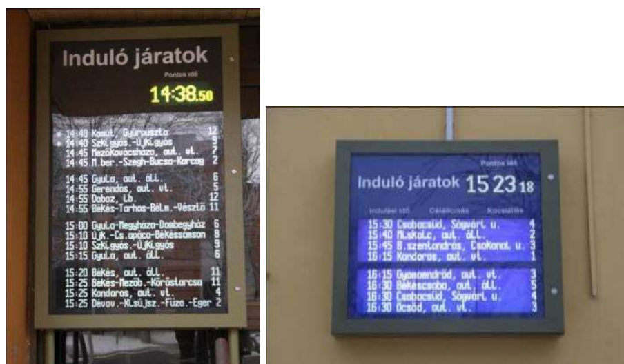
218. ábra Helyi és helyközi viszonylatok áttekintő utastájékoztatói összesítő kijelzése történhet LCD, paneleken is, háttér világítással, belső térben
