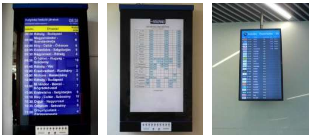
217. ábra Több közlekedési ág dinamikus érkezési információit, üzeneteket és statikus információkat megjelenítő TFT monitorok (minta)
