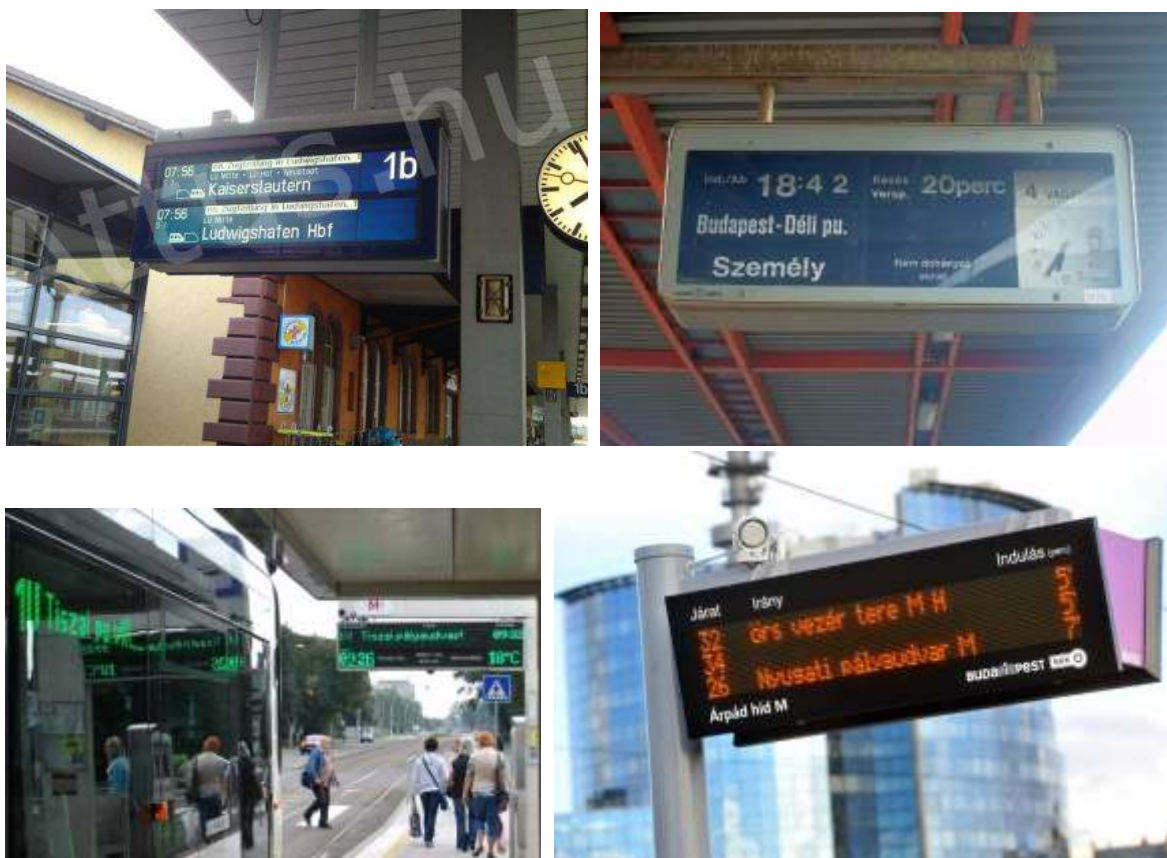
216. ábra Példák indulóhelyi, megállóhelyi valós idejű utastájékoztató kijelzőkre
