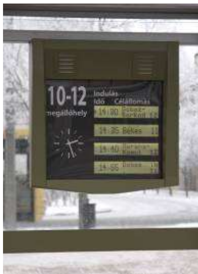
215. ábra Példa napelemes kijelzőre, vagy helyi elektromos hálózatról táplált LCD panelekre (230 V-os változat)
